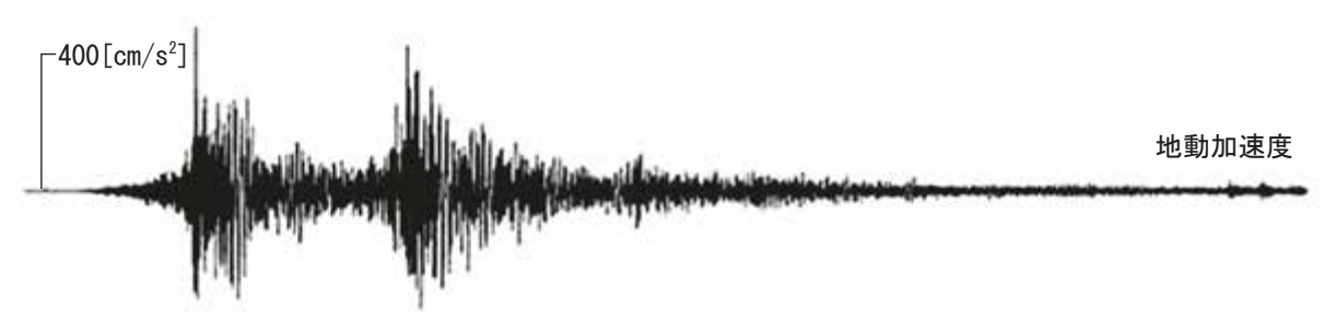
平成23年東北地方太平洋沖地震の加速度波形（石巻市にて観測） （東大地震研究所HP参照）
