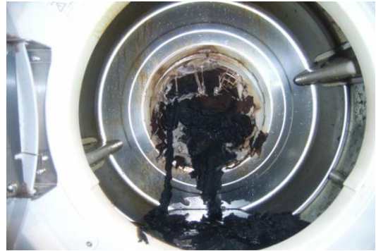
写真 2-2 乾燥機内のタオル等の焼損状況
