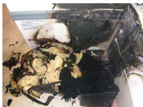
写真1-2 かご内の衣類等の焼損状況
