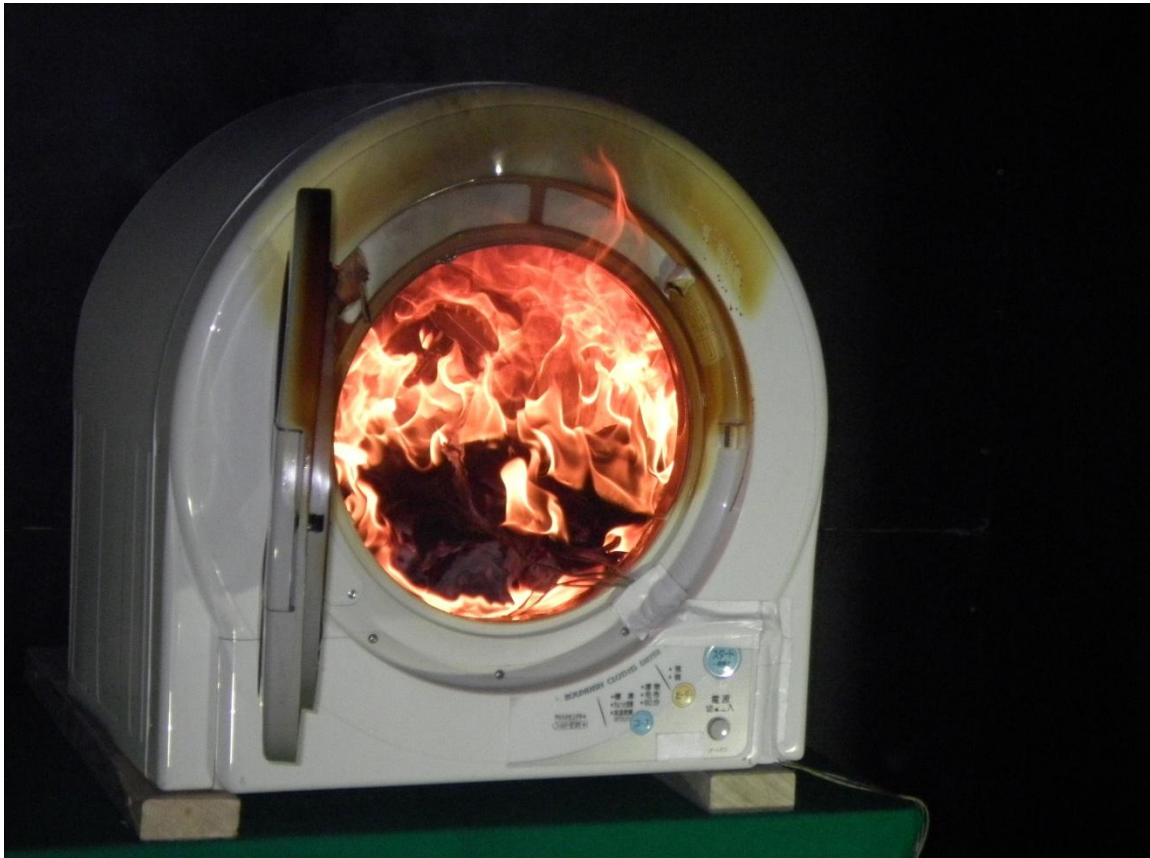
(2) 電気衣類乾燥機内のタオルから炎が出ている状況
