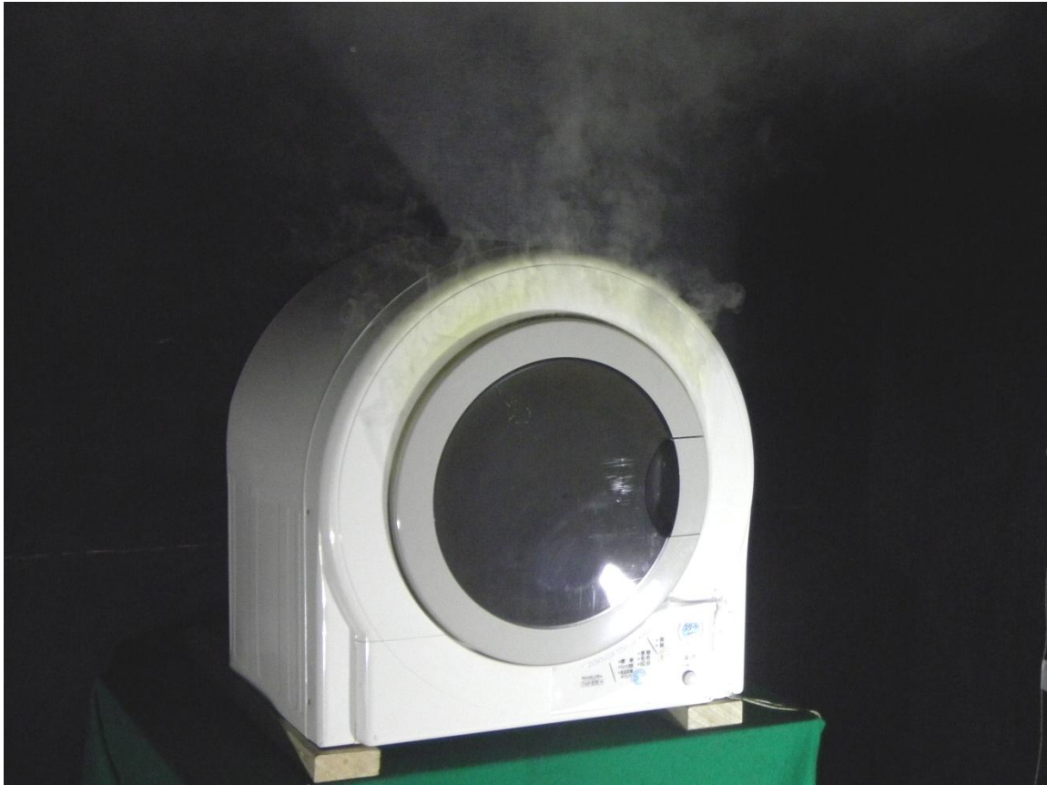
(2) 電気衣類乾燥機内のタオルから炎が出ている状況
