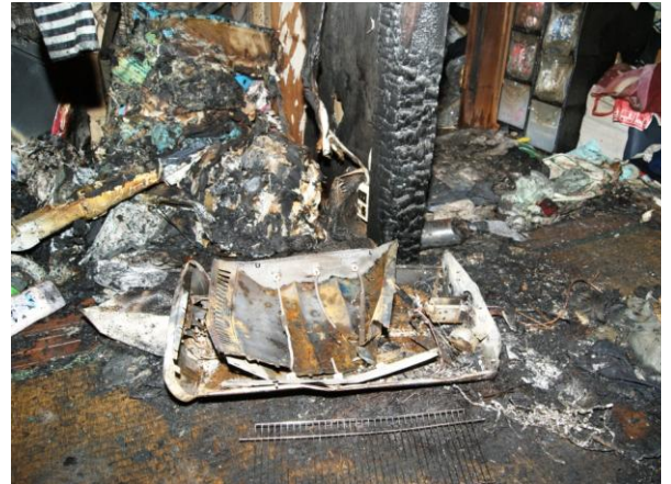
写真 1-2 電気ストーブの状況
