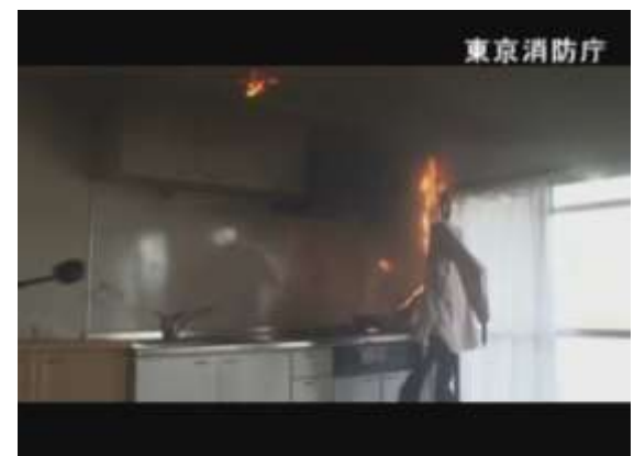
写真4 炎の拡大が終息し、周囲のカーテンに延焼している状況
