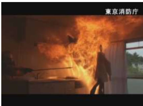
写真3 水をかけた直後に炎が急激に拡大している状況
