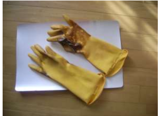
写真2 ゴム手袋の焼損状況
