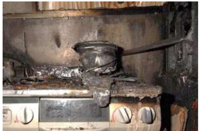
写真 1-2 焼損した電気炊飯器の状況
