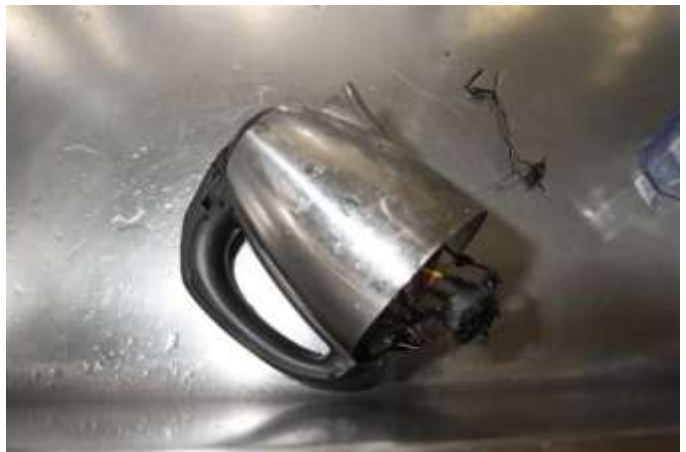
写真 2-2 底部のヒータ部分が焼損した状況
