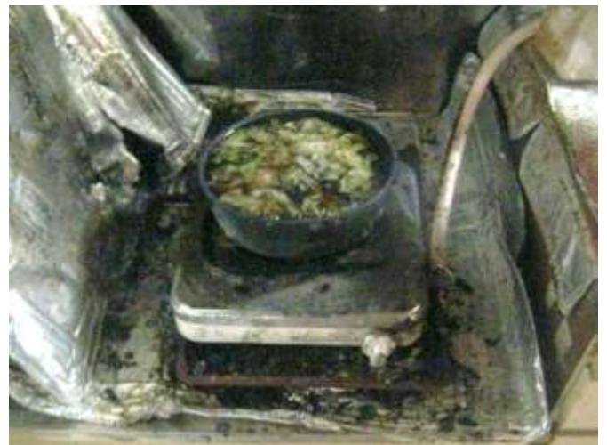
写真 2-2 焼損した調理器具の状況
