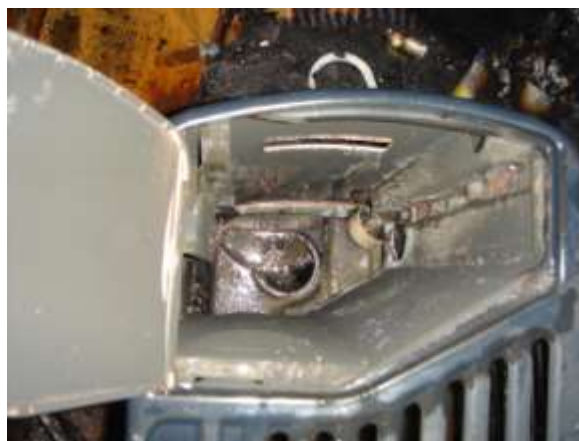
写真 1-2 外れた燃料キャップ
