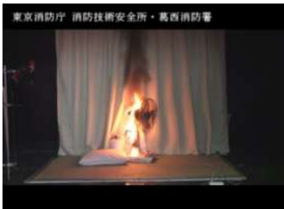
写真5 合成樹脂部分が熔融し、台座に延焼拡大している状況
