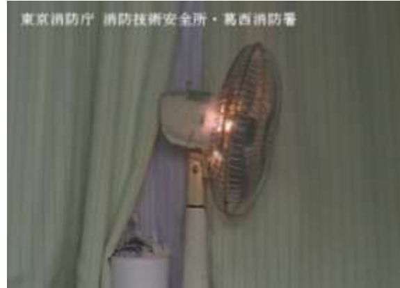
写真4 黒煙を伴い激しく延焼する扇風機の状況
