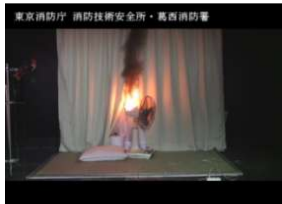
写真6 台座の焼損により扇風機が転倒し、収容物に延焼拡大している状況
