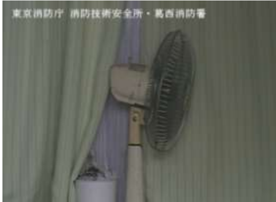
写真3 合成樹脂部分に着火した直後の状況
