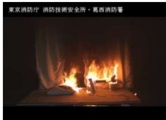
写真6 台座の焼損により扇風機が転倒し、収容物に延焼拡大している状況
