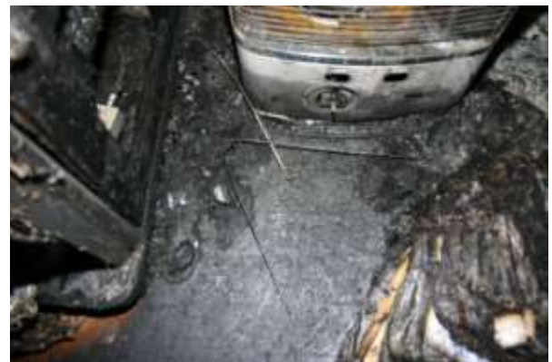
写真 2-2 石油ストーブの状況 (手前に洗濯ハンガーの針金)
