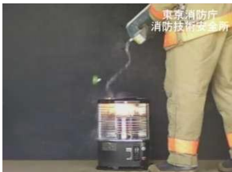
カートリッジタンクから灯油がこぼれた状況
