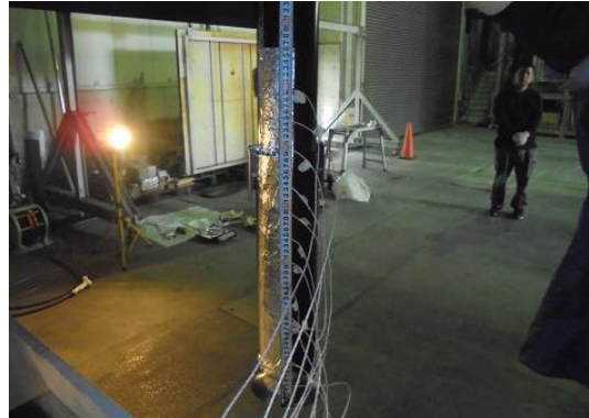
写真6-47 上引きダクト外部へ熱電対設置
