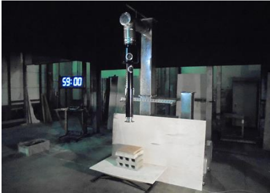
写真6-46 5m集煙フードへ上引きダクト設置
