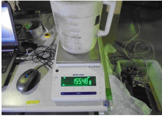
写真6-58 ヘプタン 155g 計量中
