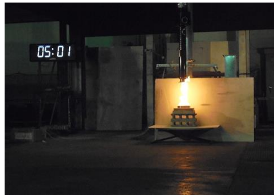
写真6-79 火皿 20cm 風速 7m/s 離隔距離 40cm
