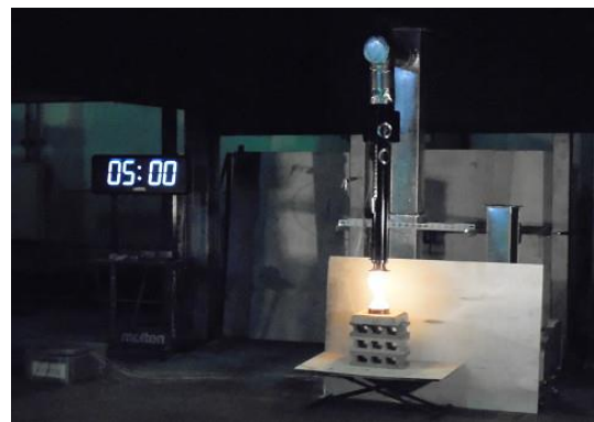
写真 6-101 実験③ 火皿 15cm 離隔距離 30cm 風速 3m/s
