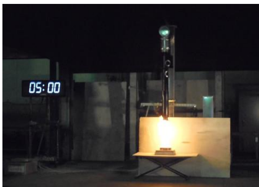
写真6-80 火皿 20cm 風速 7m/s 離隔距離 50cm
