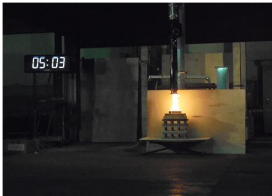
写真6-78 火皿 20cm 風速 7m/s 離隔距離 30cm
