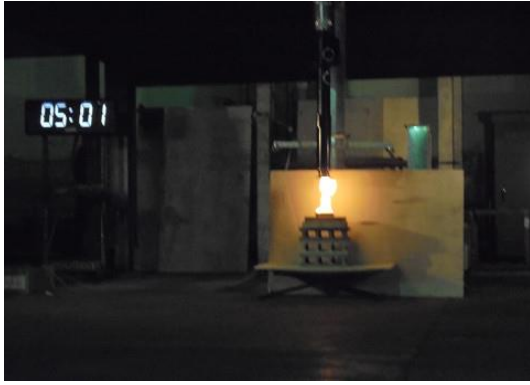
写真 6 - 64 火皿 15cm 風速 5m/s 離隔距離 30cm
