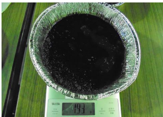
写真6-85 ダクト内塗布試料（油塵） 193g
