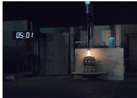
写真6-63 火皿 15cm 風速 5m/s 離隔距離 20cm
