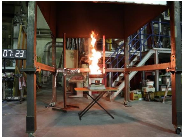
写真5-4 燃焼発熱挙動の計測状況(七輪大ホルモン 500g)
