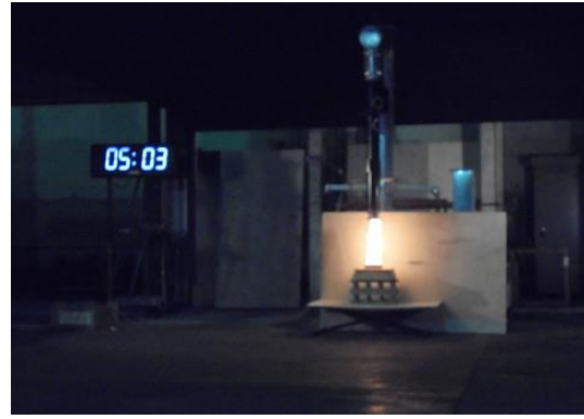
写真 6 - 65 火皿 15cm 風速 5m/s 離隔距離 40cm
