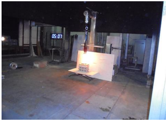
写真6-112 実験⑒ 火皿 20cm 離隔距離 40cm 風速 5m/s
