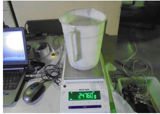
写真6-59 ヘプタン 247.5g 計量中
