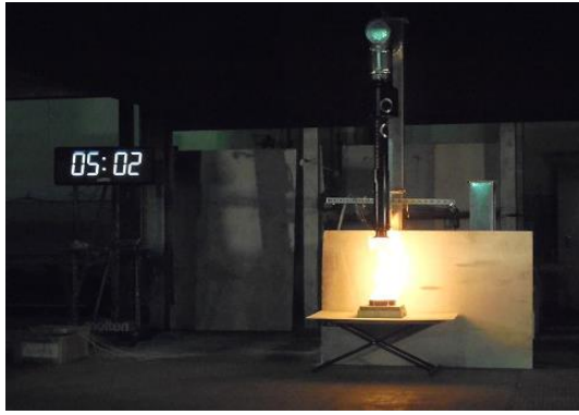
写真6-76 火皿 20cm 風速 5m/s 離隔距離 50cm
