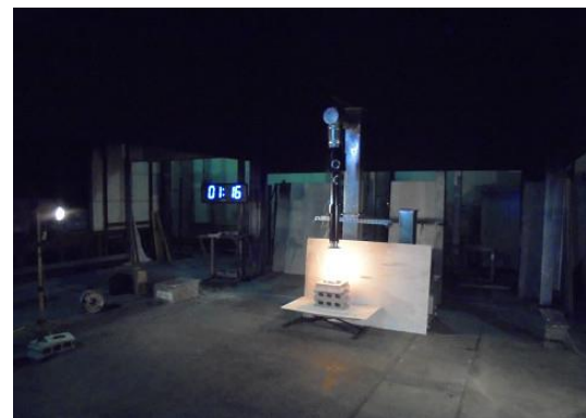
写真6-115 実験㉒ 火皿 20cm 離隔距離 40cm 風速 7m/s
