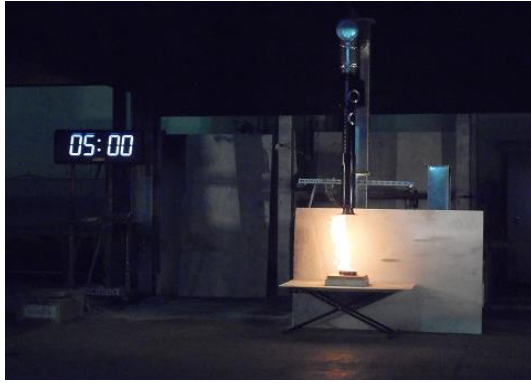
写真6-70 火皿 15cm 風速 7m/s 離隔距離 50cm
