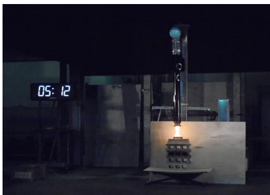
写真6-60 火皿 15cm 風速 3m/s 離隔距離 20cm
