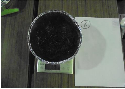
写真6-87 ダクト内へ試料塗布後 残滓 67g
