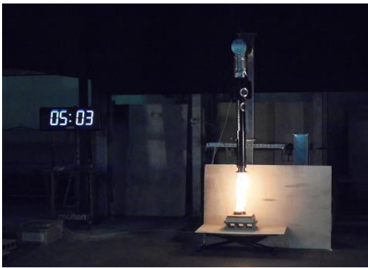
写真 6 - 66 火皿 15cm 風速 5m/s 離隔距離 50cm
