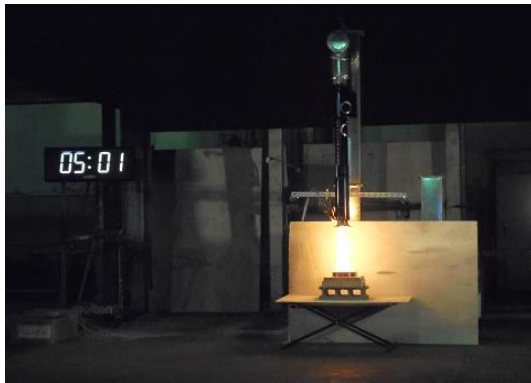
写真6-72 火皿 20cm 風速 3m/s 離隔距離 40cm
