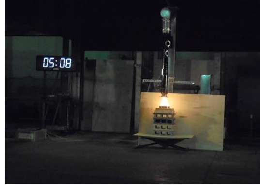
写真6-77 火皿 20cm 風速 7m/s 離隔距離 20cm
