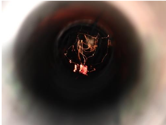
写真5-11 ダクト内部に着火した状況（着火有）
