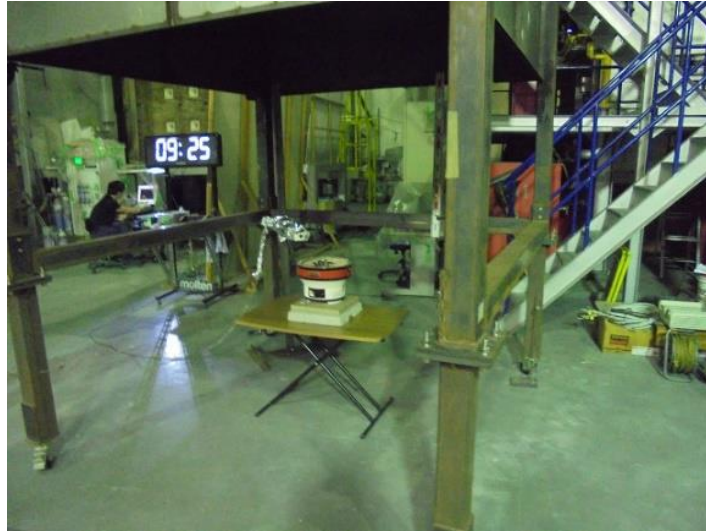
写真5-3 集煙フード(2m×2m)に設置した七輪の状況
