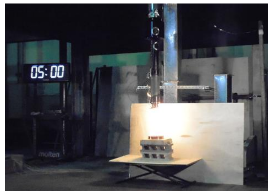
写真6-109 実験⑭ 火皿 20cm 離隔距離 40cm 風速 3m/s
