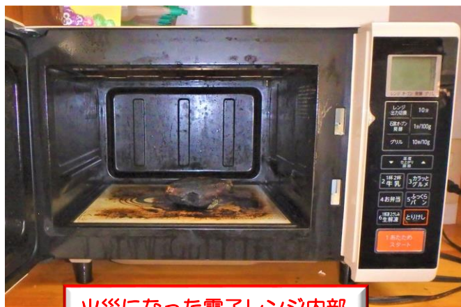
火災になった電子レンジ内部
