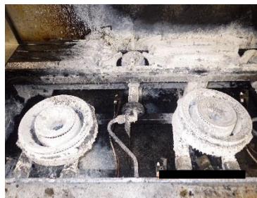
焼損したガスコンロの状況（写真の白い部分は簡易自動消火装置が作動し、噴出した薬剤）
