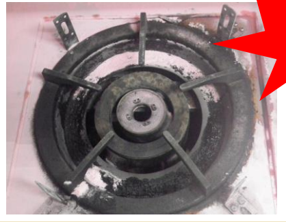
汁受けに燃えて炭化した油かすが付着している状況
