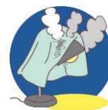
④ところが、時間の経過で接触抵抗が大きくなり火災に・・・
