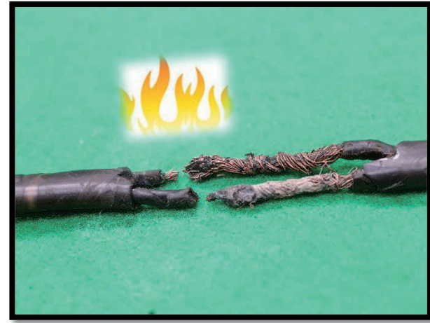
④ところが、時間の経過で接触抵抗が大きくなり火災に・・・
