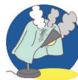
④ところが、時間の経過で接触抵抗が大きくなり火災に・・・
