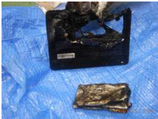
焼損したリチウムイオン電池
