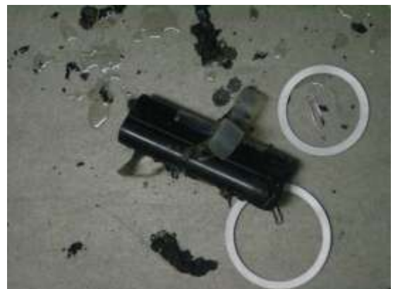
焼損したニカド電池とクリップ
