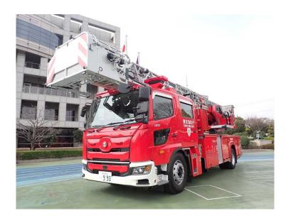
全長 10.30m 全幅 2.49m 全高 3.30m 総重量 16.200kg
