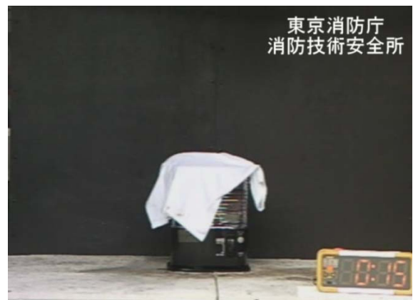
石油ストーブ上に洗濯物が落下
