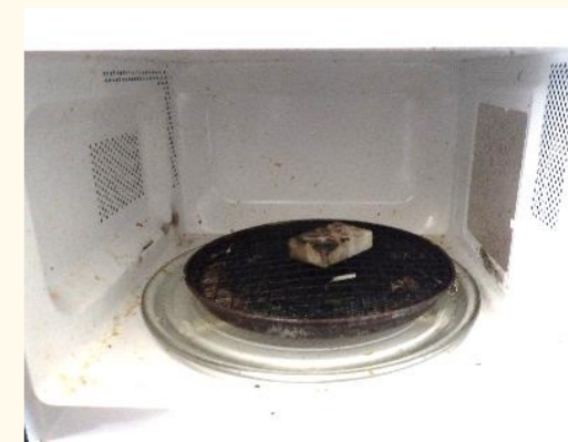
電子レンジ内の状況（焼き網と焼損した食材）
