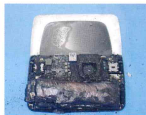
リチウムイオン電池を無理に取り外そうとし焼損
