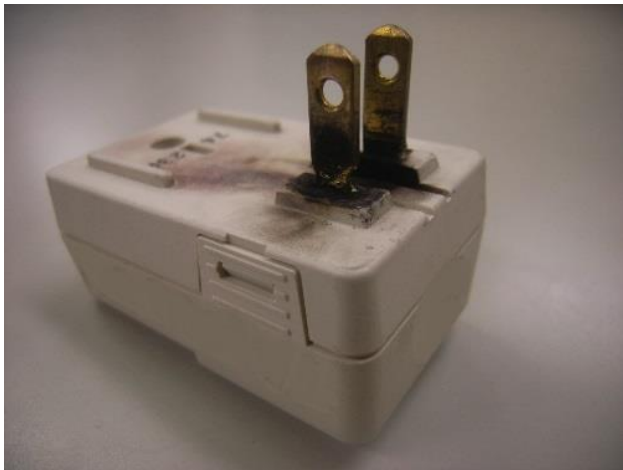
写真3-3 漏電保護タップの差し刃の焼損状況
