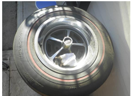
写真6 タイヤに置かれた雑巾の焼損状況
