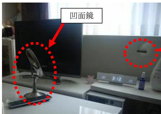
写真3 凹面鏡と焼損箇所の状況
