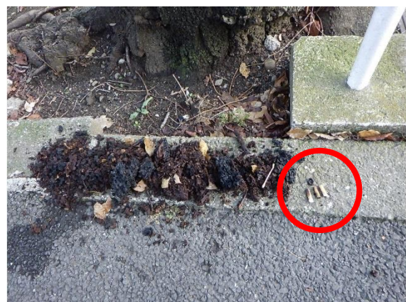
写真14 焼損物内の状況（赤丸吸い殻）
