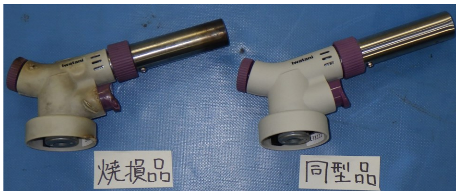
写真7 ガスバーナの焼損状況
