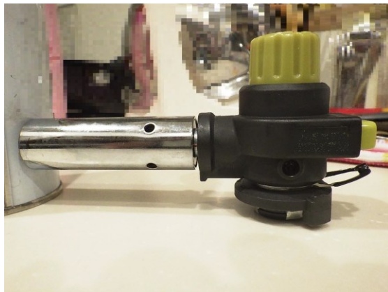
写真5 ガスバーナの焼損状況
