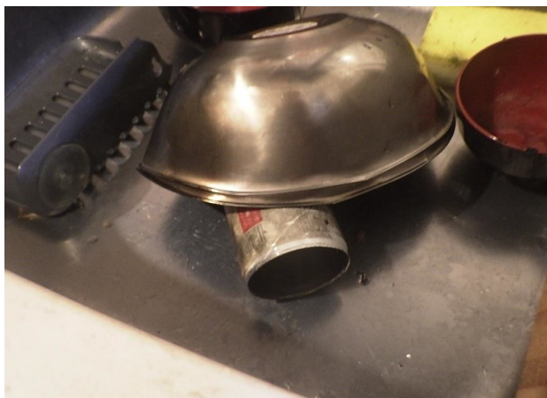
ボウルを覆いかぶせてボンベの底面が破裂した状況
