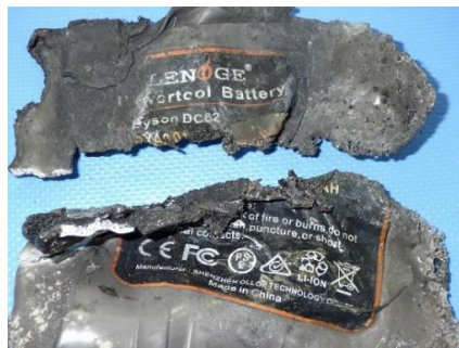
写真2 バッテリーパックの 焼損状況（非純正品）
