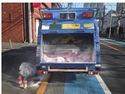
写真5 ごみ収集車の焼損状況
