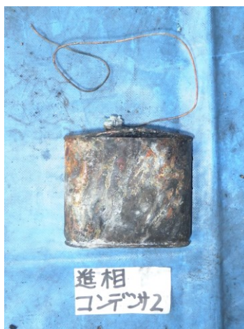
写真4 低圧進相コンデンサの焼損状況
