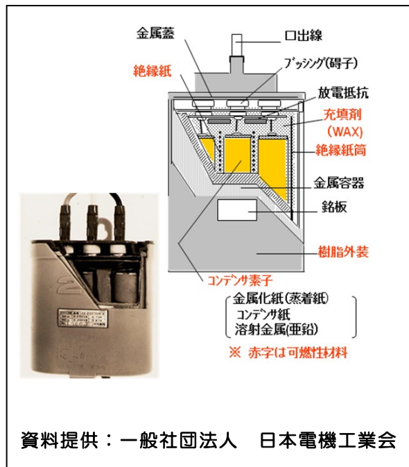
低圧進相コンデンサの構造
