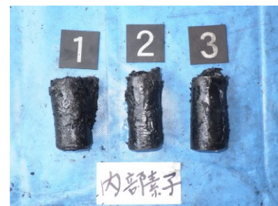
写真4 低圧進相コンデンサの焼損状況
