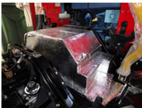
消防ポンプ補助装置用 リチウムイオンバッテリー
