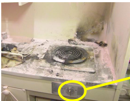
写真3 電気こんろの状況 (つまみが脱落している)
