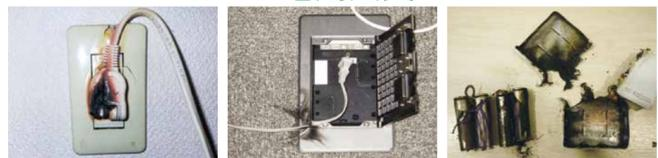
コンセントに差した状態で燃えて壊れたモバイルバッテリー
