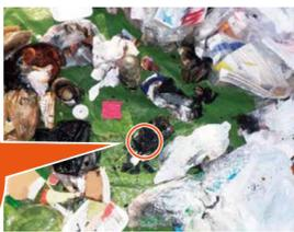
収集したゴミの中でつぶれて発火したリチウムイオン電池
