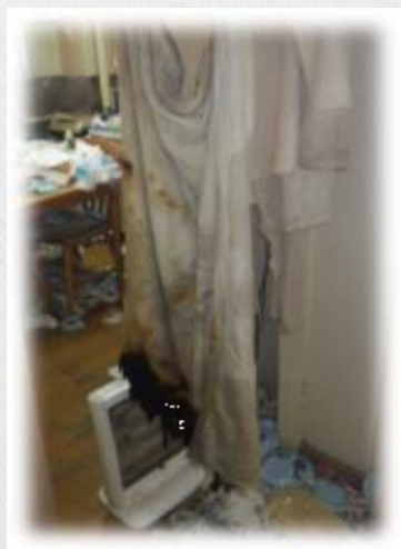
電気ストーブに洗濯物が接触し焼損した状況
