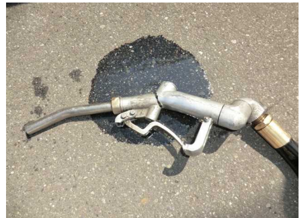
破損した給油ノズル
