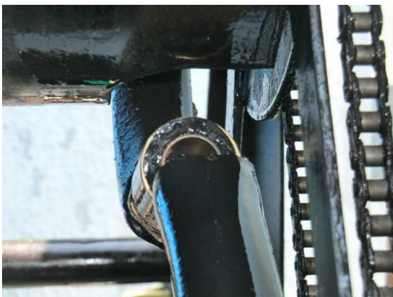
脱落により破断したホース
