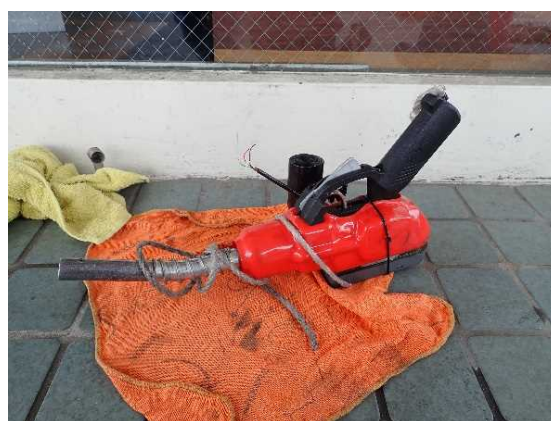
離脱した給油ノズル
