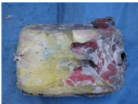
焼損したガソリン携行缶 (封をしていたラップは燃え、密閉していなかった状態がわかる。)
