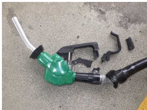
破損した給油ノズルの様子
