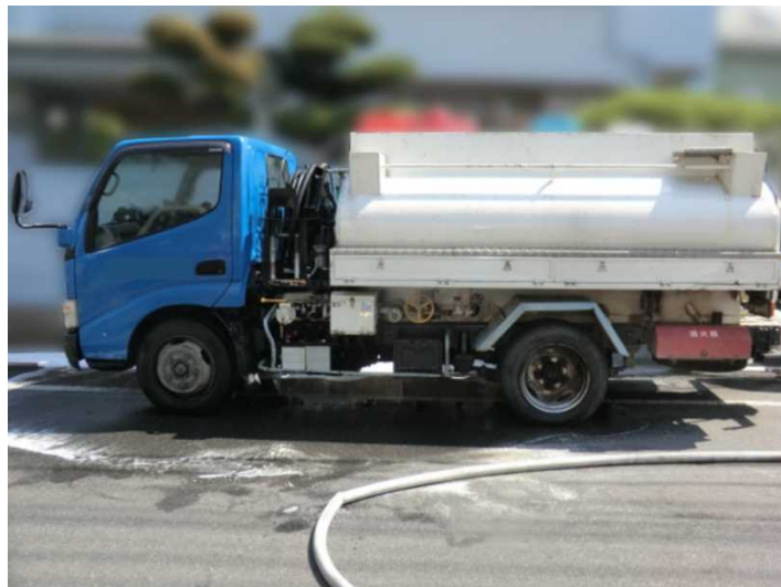
移動タンク貯蔵所からの軽油の流出状況
