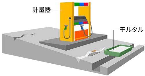
モルタル、コーキング措置
