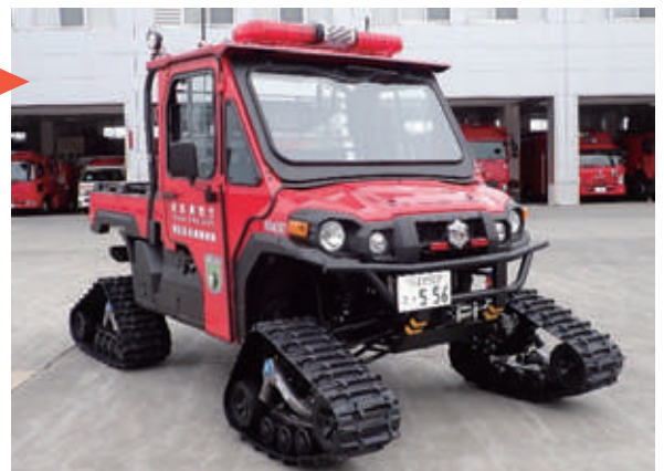
クローラー装着状況
