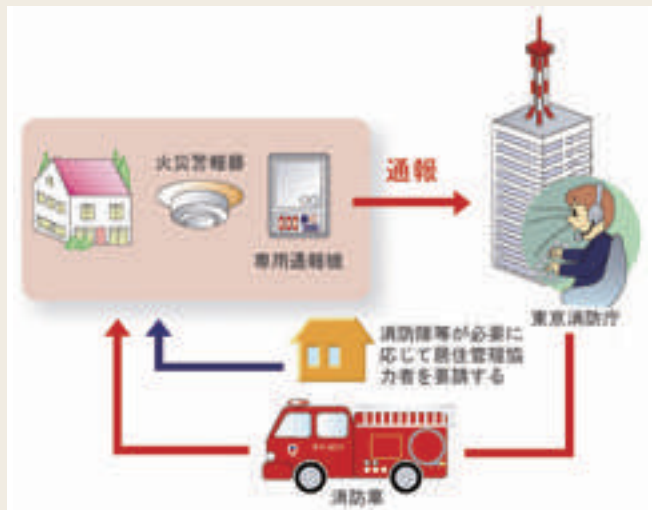
■ 図表2-5-17 住宅火災直接通報のしくみ
