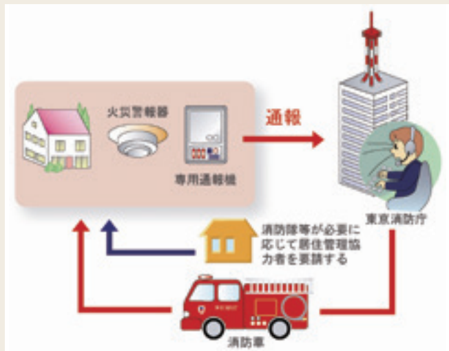
■ 図表2-5-17 住宅火災直接通報のしくみ
