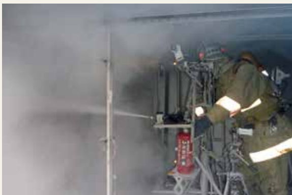
▲ 消火器を用いた初期消火の燃焼環境の変化に関する検証
