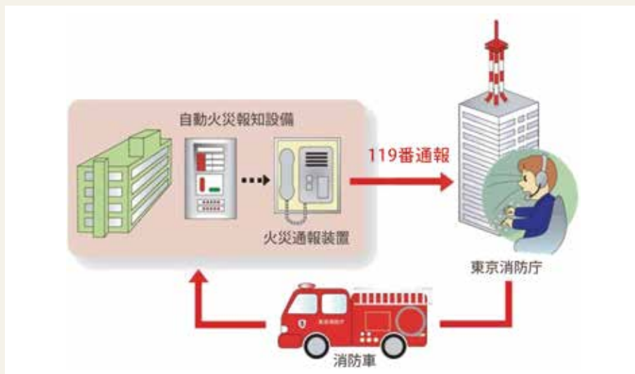
■ 図表2-6-13 事業所火災直接通報のしくみ
