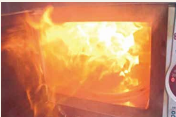
▲ 電子レンジで食品を長時間加熱することにより発生する急速な燃焼に関する検証
