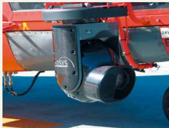
▲ 消防ヘリコプターに装備されたヘリコプターテレビ電送装置（カメラ）
