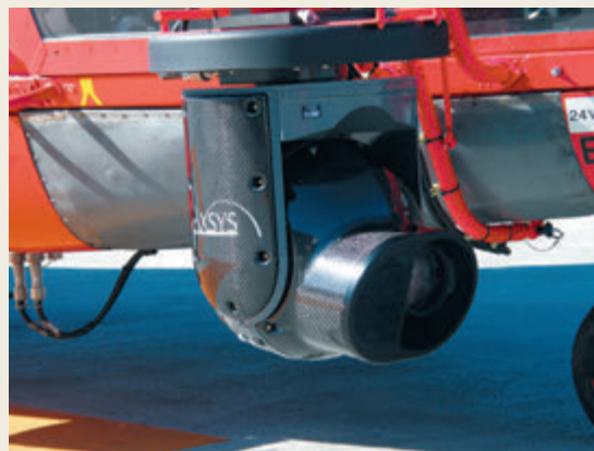
▲ 消防ヘリコプターに装備されたヘリコプターテレビ電送装置 (カメラ)
