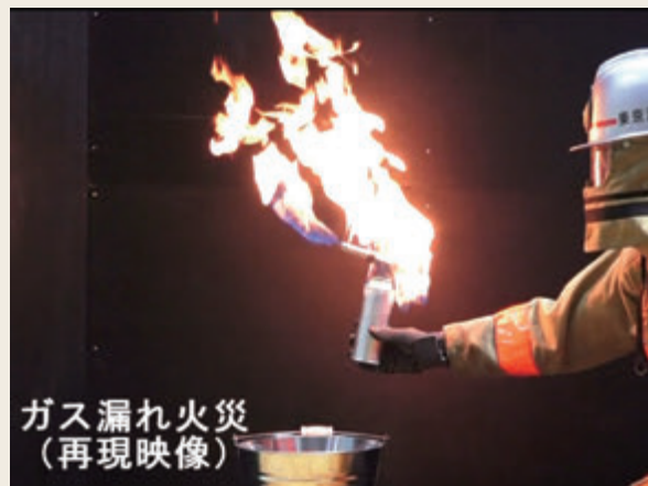
▲ ガスストーブバーナーに起因した火災の再現実験
