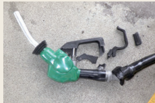
▲破損した給油ノズル
