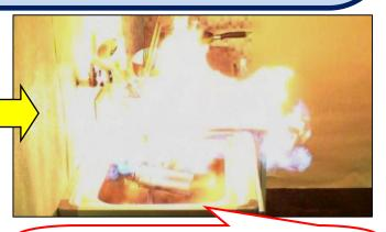
流し台の中に滞留したガスに引火し、炎 が拡大しています。
