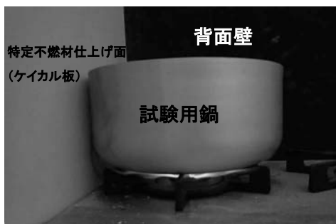
図 13 ケイカル板仕上げ加熱時の状況
