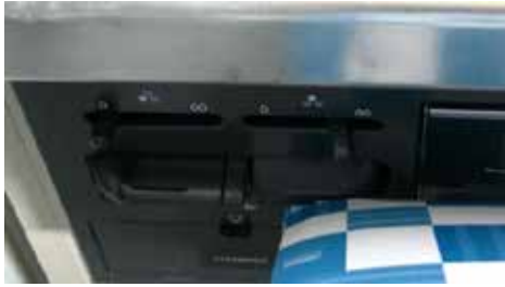
写真10 収納物がスイッチ部分にあたり、火を点く
