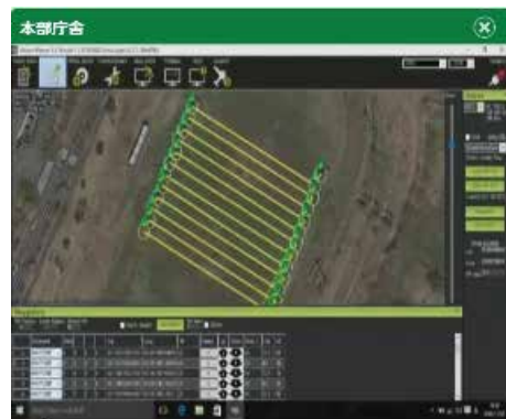
写真11 現場PC画面（飛行経路設定画面）
