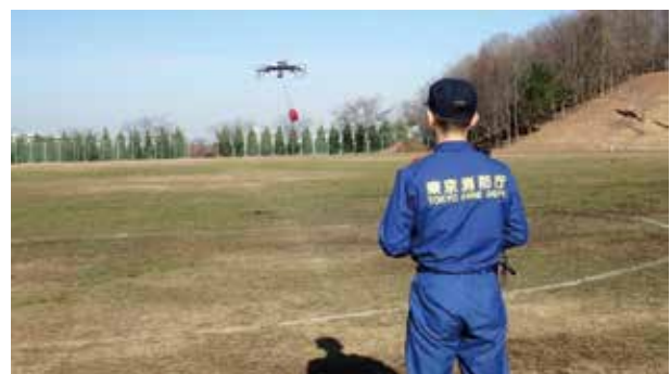
写真6 G P S マーカー子機の搬送状況
