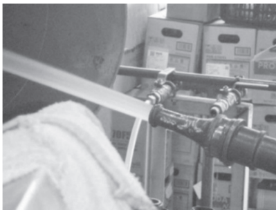
写真 16 落差 8.3mでの放水状況
