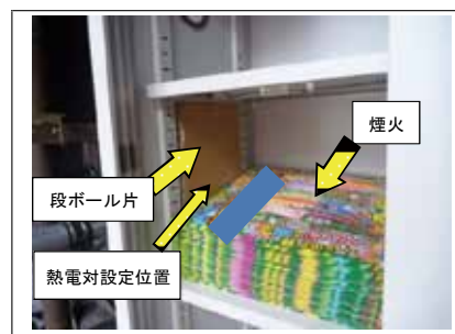
図 10 煙火収納状況例 (保管方法：スチールロッカー)
