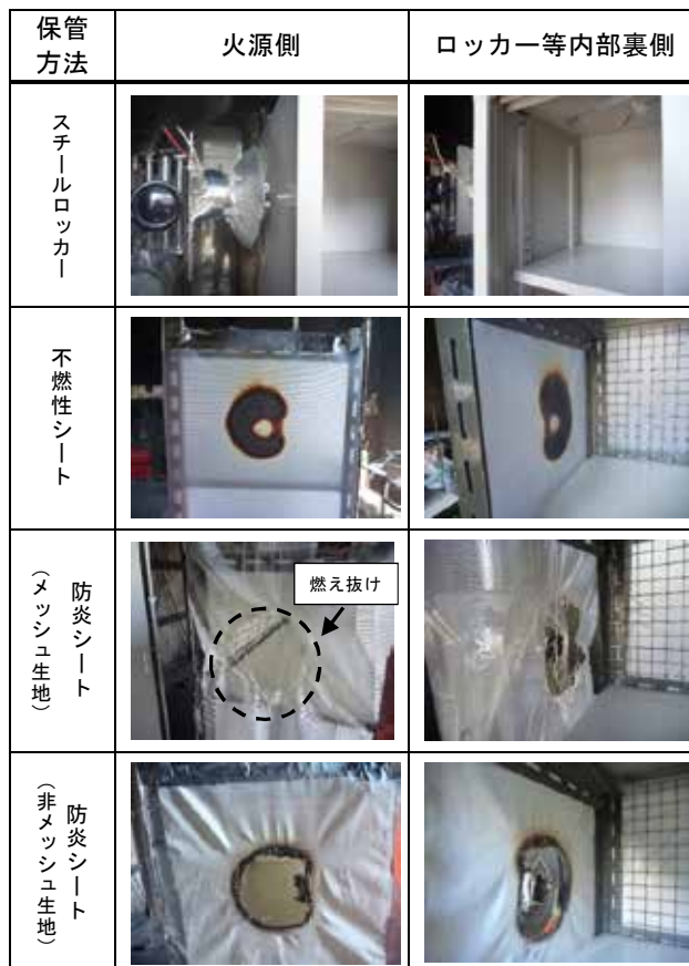
図7 実験後の受熱面の状態 (火源：ハロゲンヒーター)
