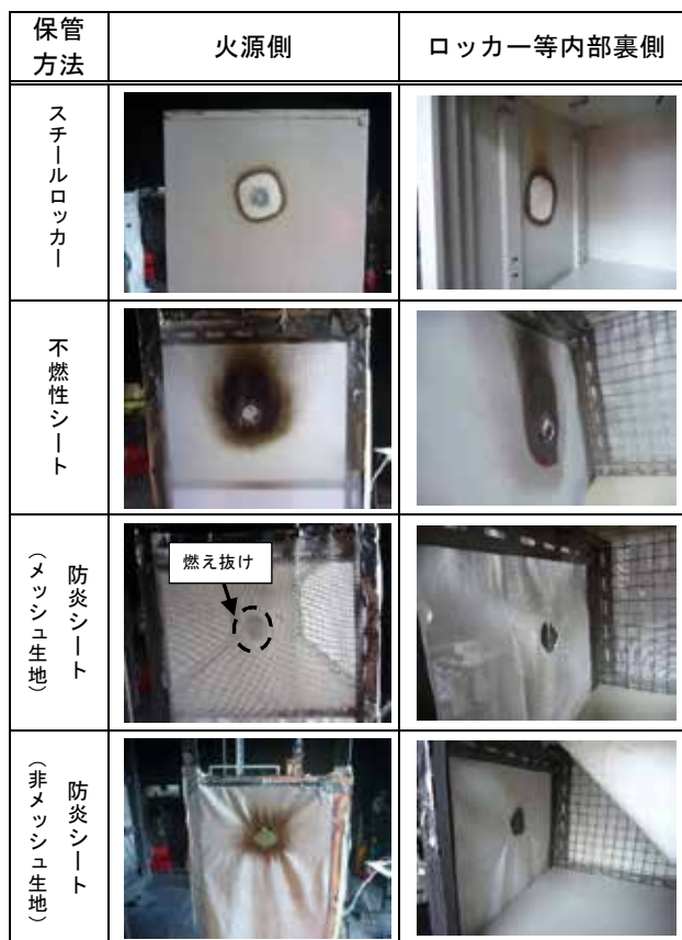
図6 実験後の受熱面の状態 (火源：ガストーチ)
