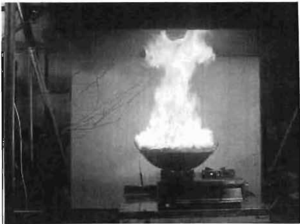
写真2 厨房火災実験の状況
