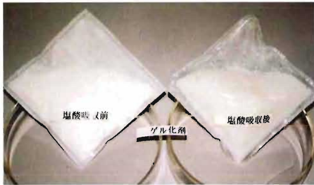
写真6 塩酸吸収前後の供試体J ゲル化剤（スミカゲル）は塩酸を吸収すると若干膨潤する。
