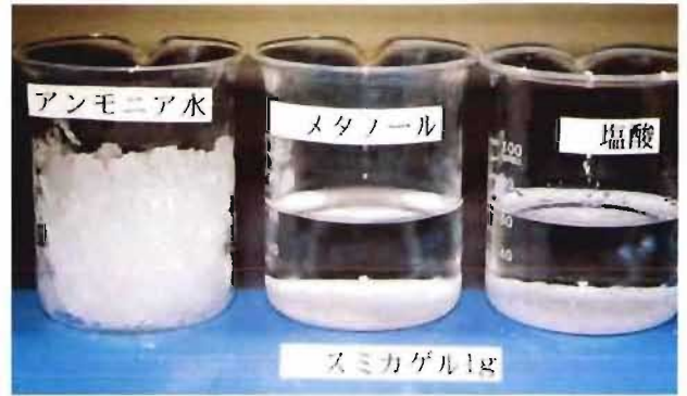
写真7 スミカゲルのゲル化の状況 スミカゲルはアンモニア水を迅速にゲル化するが、メタノールに対するゲル化は認められない。
