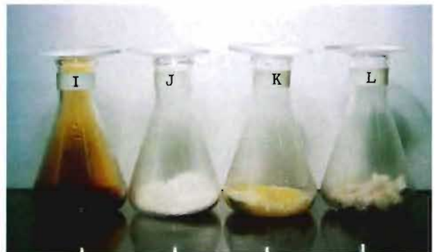
写真11 硝酸を加えた吸収剤から赤褐色の窒素酸化物が発生するか否かを確認している状況。 吸収剤J～Lは高吸水性樹脂を含むグループであるが、赤褐色のガスは発生しない。
