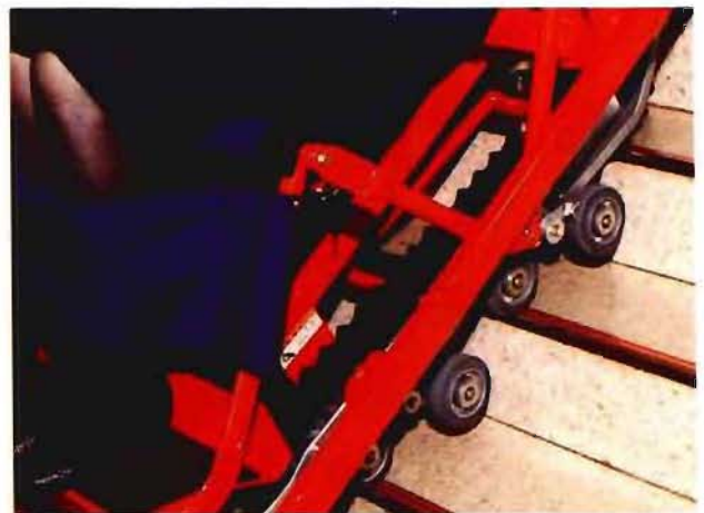
写真4 平地走行用車輪（階段昇降時）
