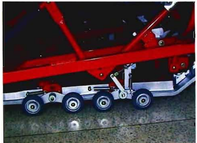
写真3 平地走行用車輪（平地走行時）
