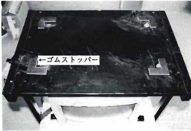
写真6 ゴムストッパーの設置状況
